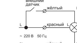
б) Схема подключения при использовании внешнего датчика с использованием функции дежурного освещения
