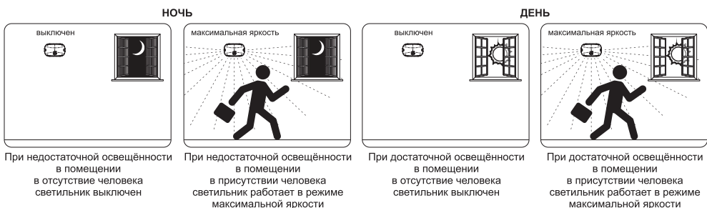
Рисунок 5 — Схема работы светильника SA-7008U в режиме I
