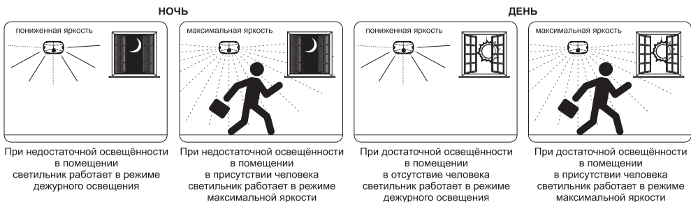
Рисунок 6 — Схема работы светильника SA-7008U в режиме II
