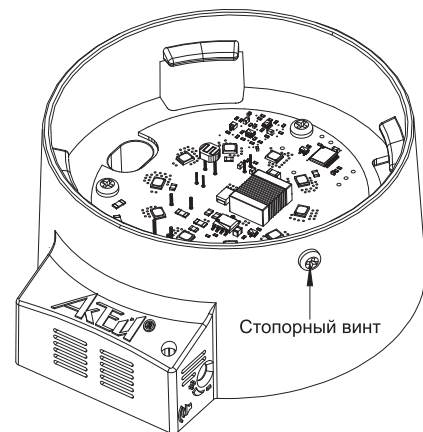
Рисунок 1 — Внешний вид основания СА-26
